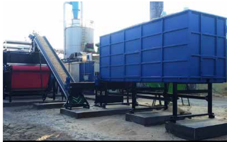
Suszarnie ECO-Dryers usuwają z materiału od 300 do 1200 kg wody na godzinę. Fot. AMS elektronik
