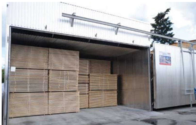
Suszarnie kontenerowe AMS elektronik mogą być wykonane w wielu wariantach różniących się kubaturą załadunkową oraz użytym systemem sterowania.
